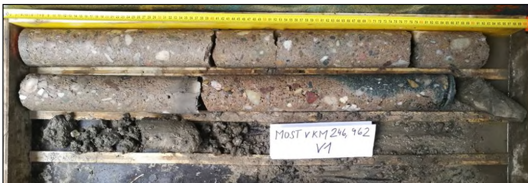
Obr. č. 2 - diagnostický vrt V1 dříku zdi - v km 246,963
