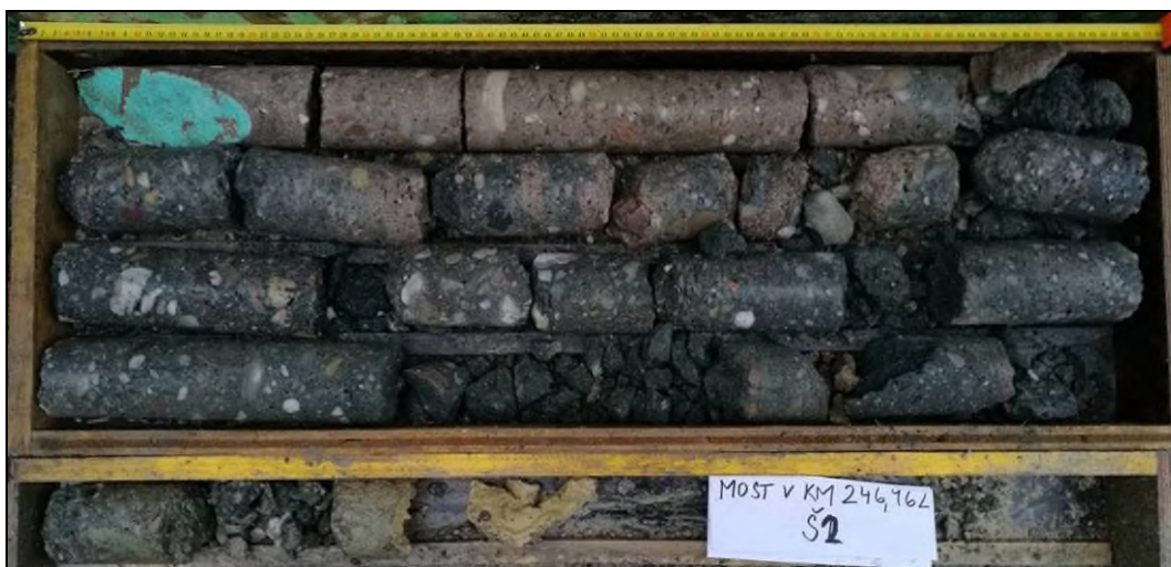
Obr. č. 3 - diagnostický vrt Š2 do dříku zdi - v km 246,973
