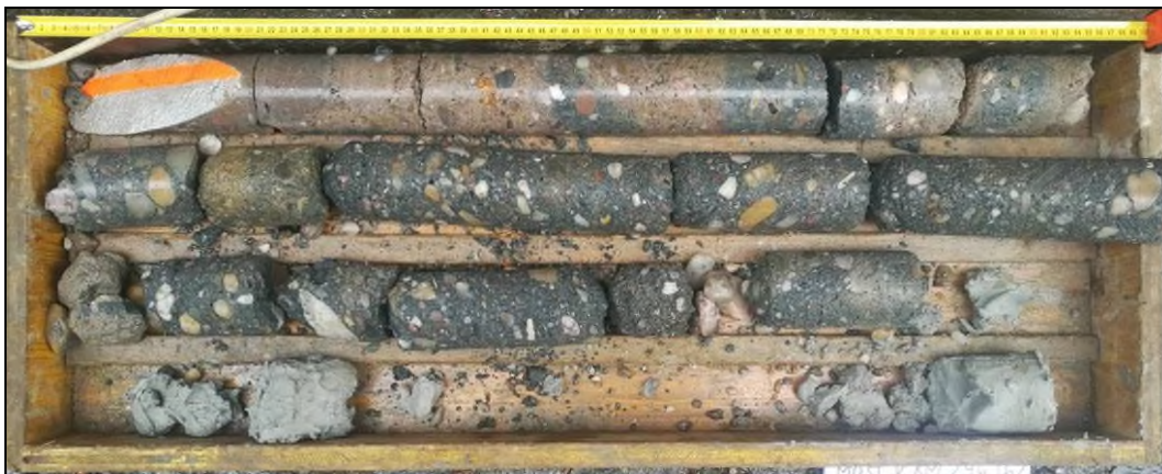
Obr. č. 1 - diagnostický vrt Š1 do dříku zdi - v km 246,963
