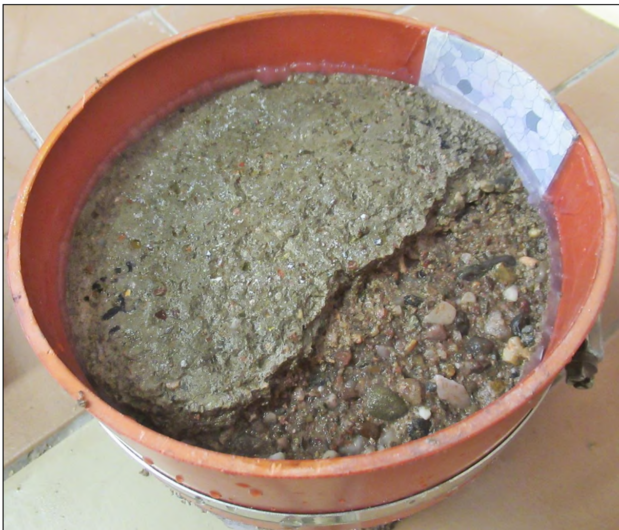
Foto 5: Líc vzorku CHRL1 po zkoušce – 75 cyklů Zaznamenán postupný rozpad lící plochy z jedné strany zkušebního vzorku – odlupování omítky a rozpad betonu až do hloubky cca 15 mm.
